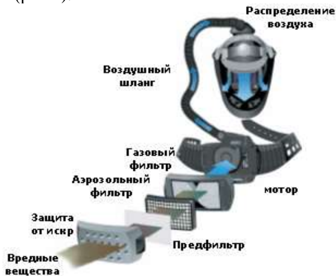
Рис.2. Конструкція «Speedglas» і блоку «Adflo».
