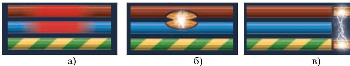
Рис.1. Основні види електричного замикання та перевантаження, які можуть мати місце в електромережах низької напруги
