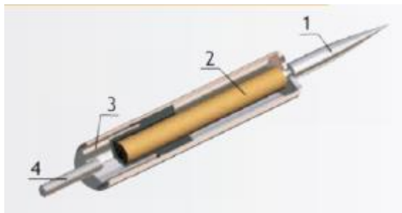
Рис. 5. Конструкція блискавкоприймача Gromostar: 1 – наконечник блискавкоприймача; 2 – високовольтна система (котушка індуктивності); 3 – генератор імпульсної напруги та іскровий зазор; 4 – з'єднувальна муфта M16
