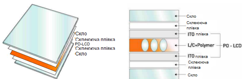
Рис. 2. Конструкція «розумного» скла для вікон
